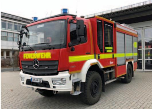
Der Gesamtwert des Fahrzeuges beträgt rund 235.000 Euro. Alleine die Ausrüstung hat einen Wert von etwa 45.000 Euro. Durch den kurzen Radstand (3.860 mm), die kompakten Abmessungen (eine Länge von 7.210 mm) und die absolute Bedienerfreundlichkeit der Pumpe hat das Fahrzeug schnell Freunde bei den Maschinisten gefunden.
