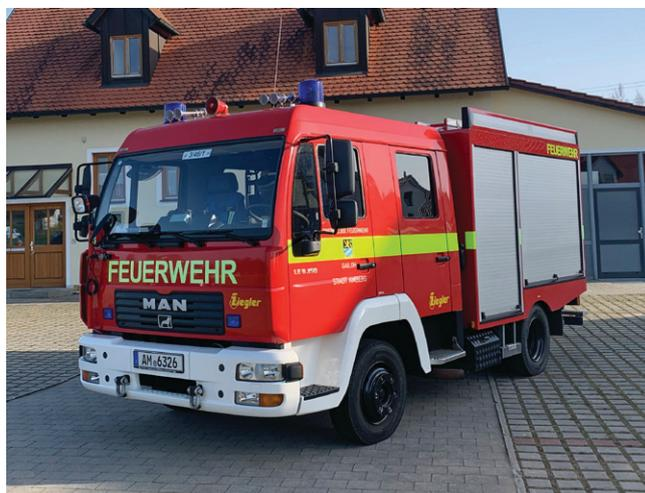
**Tragkraftspritzenfahrzeug - TSF**
