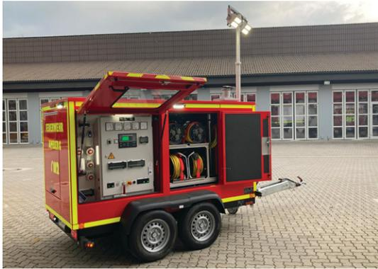
Am 19. Mai 2020 holten drei Kameraden bei der Firma Polyma in Kassel den ersten von insgesamt fünf Feuerwehranhängern Strom ab. Die Ausschreibung erfolgte über den Katastrophenschutz der Stadt Amberg und er wurde bei der Feuerwehr Amberg stationiert. Der von Polyma gebaute Anhänger hat ein Gesamtgewicht von 2.300 kg. Die Leistung beträgt 100 kVA bzw. 80 kW. Angetrieben wird der Generator von einem Volvo Penta Motor mit 99 kW/135 PS Leistung.
