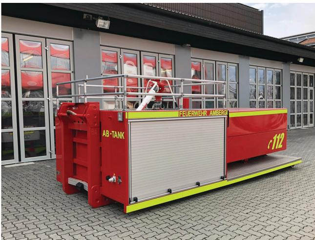
**Abrollbehälter Sonderlöschmittel - AB SLM**
