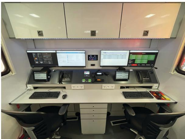
Der Funkraum besitzt zwei PC-Arbeitsplätze mit je zwei Bildschirmen - es steht zudem die Option eines dritten Arbeitsplatzes über ein Notebook bereit. Im Fahrzeug befindet sich ein DIN-A4/DIN-A3 Multifunktions-Laserdrucker. Ebenfalls ist ein iPad für verschiedene Anwendungsfälle in der Fahrerkabine untergebracht. Auf den Arbeitsplätzen wird EPSweb, EDP 4 und GeoKAT Offline als Software genutzt. Eine unabhängige Stromversorgung ist durch einen tragbaren Stromerzeuger gewährleistet.
