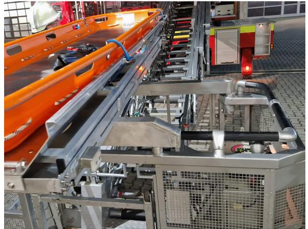
Auf dem HLF 20 (1/40/2) wurde ein neuer sog. Hebelzug mit einer Maximallast von 1,5 t und einem Hubweg von 1,5 m verlastet. Er kann als Alternative zum Mehrzweckzug Z16/Z32 flexibel für techn. Hilfeleistungen eingesetzt werden. Dies kann z.B. das Heben, Ziehen oder Verzurren von Lasten sein. Er ist vertikal und horizontal nutzbar und mit Rechts-, Links- und Freilauffunktion sowie einer Lastbremse ausgestattet.
